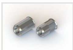
Open cilindrische blindklinkmoer met klein verzonken kop in rvs316
